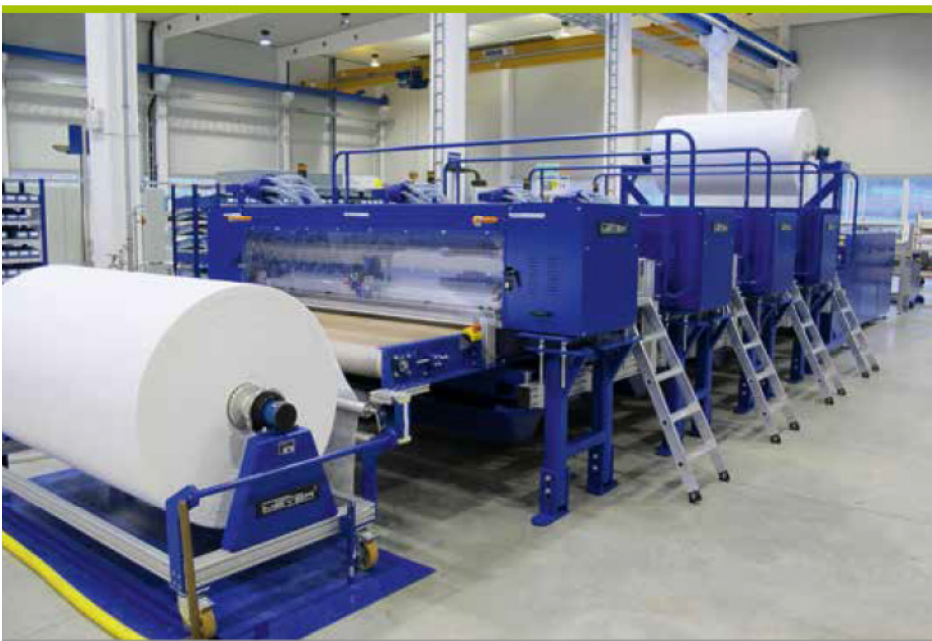
Kaschieranlage mit vier Pulverstreuern in einer Linie. Auf solchen Anlagen lassen sich beispielsweise Kohlefilter produzieren.
